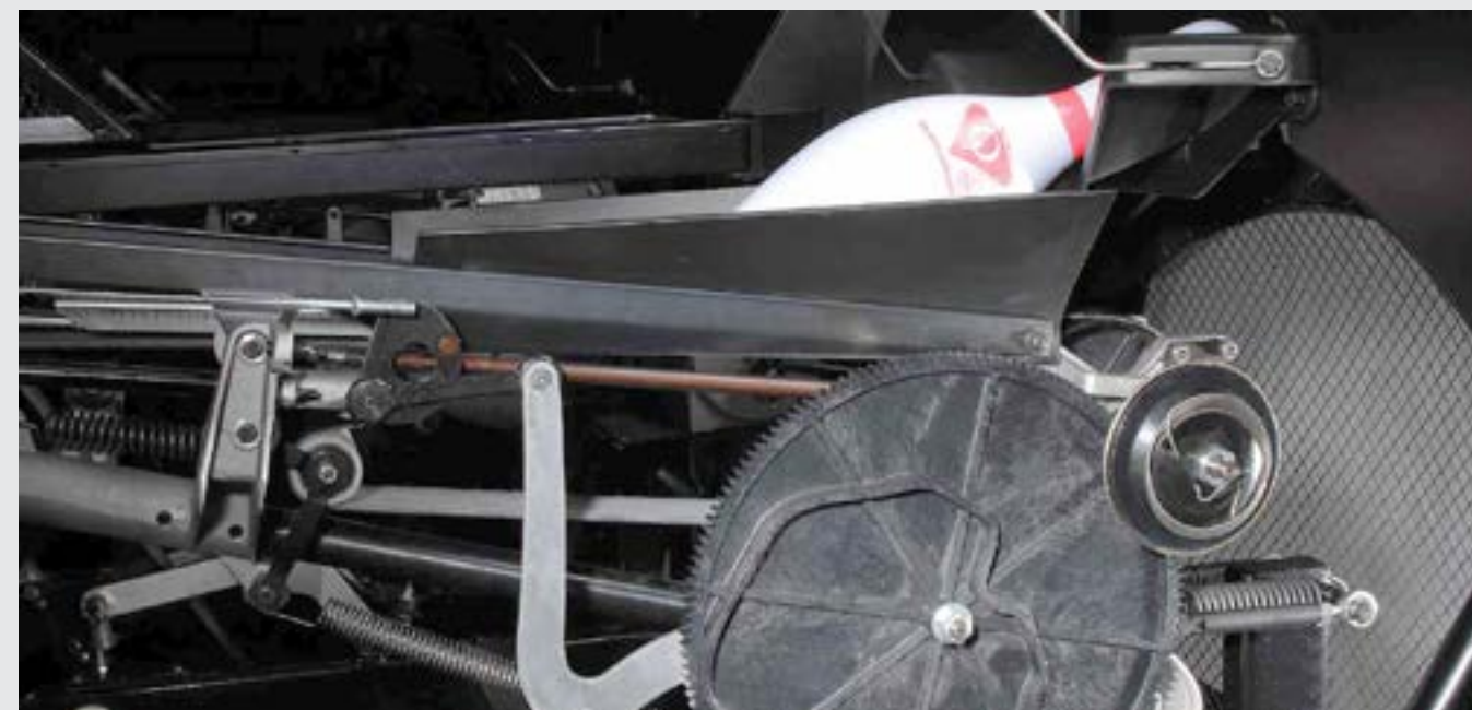
Доработанная конструкция дистрибьютора позволяет машине работать без сбоев, увеличивая срок службы кегель.
